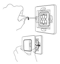
**Attention au sens de montage :** les deux ergots plastiques doivent être placés à gauche.
