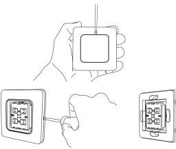
Fixez votre interrupteur à l'aide d'adhésif double-face ou de vis et chevilles appropriées au type de support.
