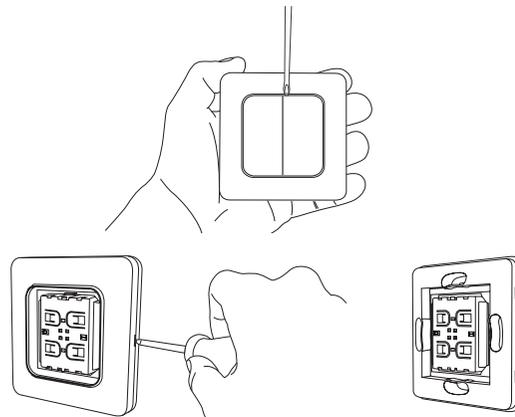
Fixez votre interrupteur à l'aide d'adhésif double-face ou de vis et chevilles appropriées au type de support.
