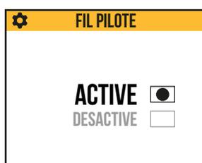
Ce mode est actif quand le radiateur est commandé par une centrale de programmation, et si le paramètre fil pilote a été activé.
