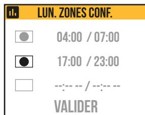
Dans, l'exemple représenté dans la figure à côté, on a sélectionné deux tranches horaires de fonctionnement en Confort, la troisième n'est pas utilisée.
