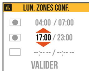
Pour configurer l'heure et les minutes, tourner le bouton et appuyer pour confirmer. L'appareil se positionnera automatiquement sur la prochaine valeur à régler. Les minutes peuvent être programmées par pas de 30.
