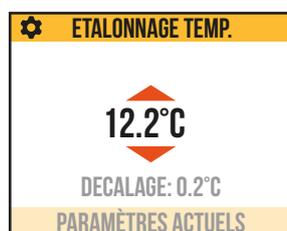
Sur l'écran est affichée la température ambiante détectée par le radiateur dans le point d'installation et la correction éventuelle déjà configurée (DÉCALAGE).
