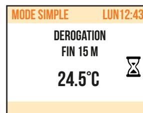
Il est possible de changer ou d'interrompre le fonctionnement temporaire en n'importe quel moment. En tournant le bouton, apparaîtra un menu qui permet d'effectuer l'annulation ou la modification :
