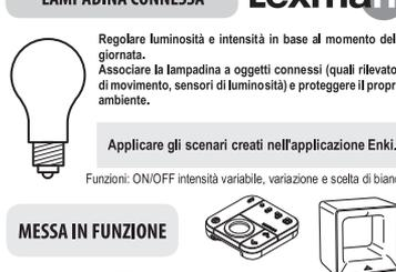
Installare la lampadina LEXMAN nell'apparecchio di illuminazione di vostra scelta. Mettere sotto tensione in posizione ON. La lampadina si accende, accendere e spegnere rapidamente la lampadina per 6 volte usando l'interruttore dell'apparecchio di illuminazione. La lampadina lampeggia 2 volte per indicare che è stata reinitializzata e pronta per essere accoppiata.
