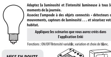
Installez l'ampoule LEXMAN dans le luminaire de votre choix. Mettez-vous sous tension en position ON. L'ampoule est allumée. Allumez et éteignez votre ampoule 6 fois de suite rapidement au moyen de l'interrupteur du luminaire. L'ampoule clignotera 2 fois pour vous indiquer qu'elle est réinitialisée et prête à être utilisée.
