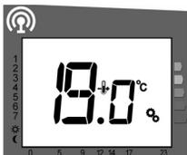
Dans cet exemple on constate 1° d'écart entre la température souhaitée et celle mesurée dans la pièce. Afin de rétablir une mesure correcte de la température ambiante par le radiateur, il faudra entrer 20° comme paramètre d'étalonnage (voir la procédure ci-après).
