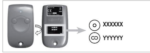
! Każdy kod przycisku pilota może być użyty do zapisania w pamięci tylko jednego napędu. W przypadku użycia kodu do zapisania w pamięci kilku napędów, centrala domowa będzie sterowała wszystkimi napędami jednocześnie.
