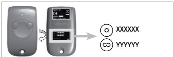
**⚠ Die einzelnen Tastencodes des Funkhandsenders dürfen nur für das Einlernen eines einzigen Antriebs verwendet werden. Wird ein Code für das Einlernen mehrerer Antriebe verwendet, steuert die Haustechnikbox alle diese Antriebe gleichzeitig an.**
