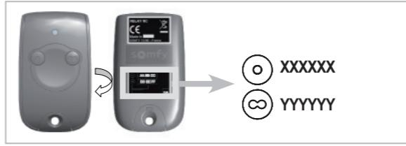
! Varje knappkod får bara användas för att spara en enda garageportsöppnare. Om du använder samma kod för att spara flera garageportsöppnare kommer hemautomationsboxen att styra alla motorerna samtidigt.
