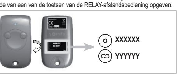
**⚠ Per toetscode van de afstandsbediening mag niet meer dan één motorisatie geprogrammeerd worden. Wanneer de code gebruikt wordt voor het programmeren van meerdere motorisaties, dan zal de domotica Box al deze motorisaties tegelijk aansturen.**
