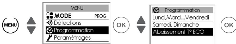
Permet de régler le niveau d'abaissement de la température que vous souhaitez effectuer en dehors des plages Confort (de -2°C à 9°C). Par défaut, il est réglé -3,5°C (si la température de consigne est réglée à 19°C, alors, en dehors des plages de Confort elle baissera jusqu'à 15,5°C).
