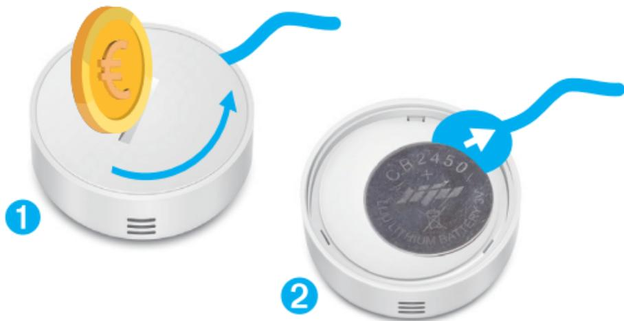
1. Utilisez une pièce de monnaie (ou autre objet plat) pour faire pivoter le compartiment à pile dans le sens inverse des aiguilles d'une montre.
