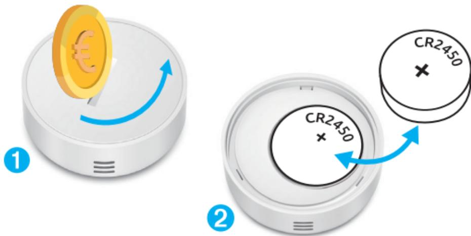
1. Utilisez une pièce de monnaie (ou autre objet plat) pour faire pivoter le compartiment à pile dans le sens inverse des aiguilles d'une montre.
