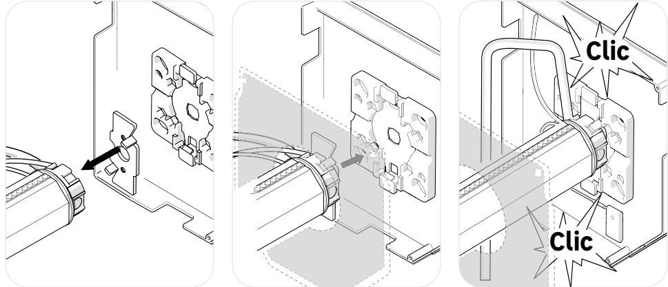
Najpierw zatrzaśnij część wspornika montażowego w głowicy silnika zgodnie z pozycją pokazaną poniżej, a następnie włożyć koniec produktu zawierający kable zasilające i komunikacyjne do dostarczonej podstawy montażowej, a następnie włożyć zacisk mocujący, aż usłyszysz kliknięcie.
