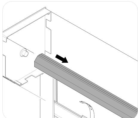
Quando substituir o motor, tenha o cuidado de proteger o cabo elétrico para evitar danificá-lo ao retirar e introduzir o motor no eixo da persiana.
