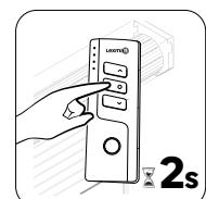
5) Pulse durante 2 segundos el botón de parada del mando a distancia y el motor girará hasta el tercer límite.
