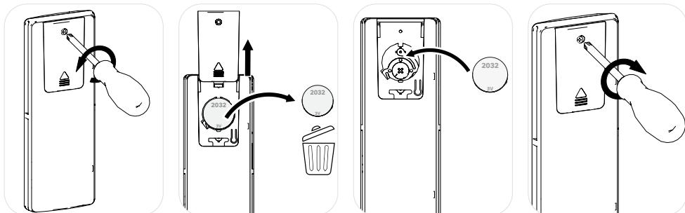
Servendosi di un cacciavite a croce, rimuovere il coperchio della batteria, sostituire la vecchia batteria con una dello stesso tipo, far scorrere il coperchio e poi riavvitarlo.
