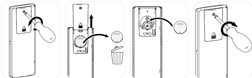
Avec l'aide d'un tournevis cruciforme, retirez le cache de la pile, remplacez la pile usagée par une pile de même type, glissez le couvercle et ensuite vissez pour le fermer.
