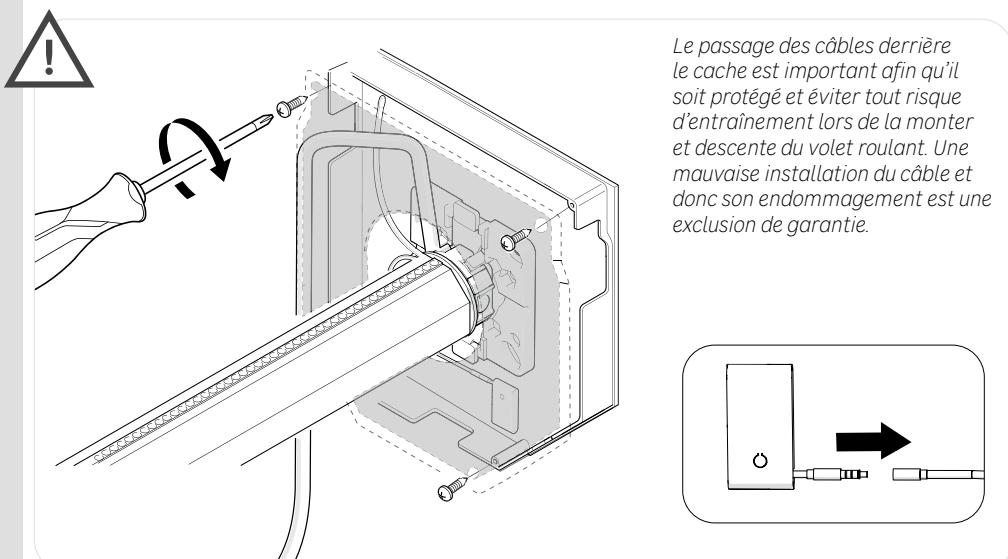
Le passage des câbles derrière le cache est important afin qu'il soit protégé et éviter tout risque d'entraînement lors de la monter et descente du volet roulant. Une mauvaise installation du câble et donc son endommagement est une exclusion de garantie.
