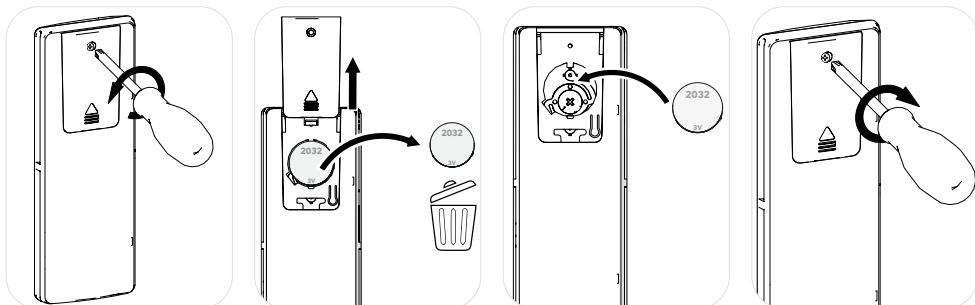
Za pomocą śrubokręta krzyżakowego zdejmij pokrywę baterii, wymień starą baterię na baterię tego samego typu, nasuń pokrywę, a następnie przykręć ją.
