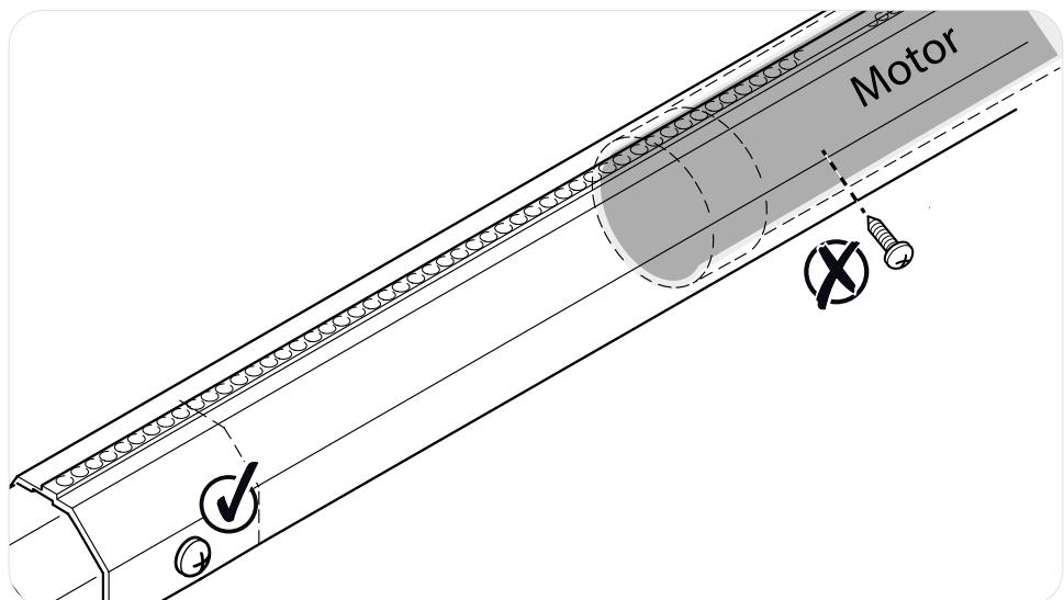
**Attention :** de ne pas visser de vis dans l'axe du volet sur toute la longueur où il y a le moteur afin d'éviter tout risque d'endommagement du moteur et risque électrique.
