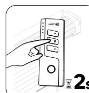
3) Pulse durante 2 segundos el botón de parada del mando a distancia y el motor girará hasta el tercer límite.
