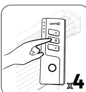
2) Despues de haber configurado el límite superior e inferior. Pulse cuatro veces sobre el botón de parada del mando a distancia.
