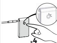
Premere quattro volte il tasto del modulo, la luce lampeggerà rapidamente. Indica che il motore entra nello stato di abbina-
