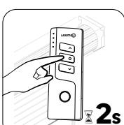
3) Appuyez sur le bouton arrêt de la télécommande pendant 2s, le moteur tournera vers la troisième limite
