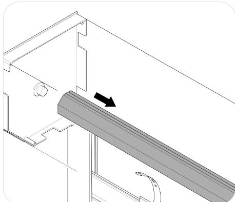
Lors du remplacement du moteur, durant le retrait et l'insertion du moteur dans l'axe du volet, veillez à protéger le câble électrique pour éviter de l'endommager.
