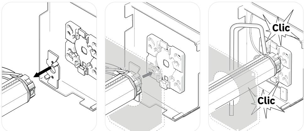
En primer lugar, enganche el soporte de fijación en el cabezal del motor en la posición indicada anteriormente y, después, inserte la parte del producto en la que se encuentran los cables de alimentación y de comunicaciones en la base de fijación suministrada y, a continuación, inserte el clip de sujeción hasta que oiga un clic.
