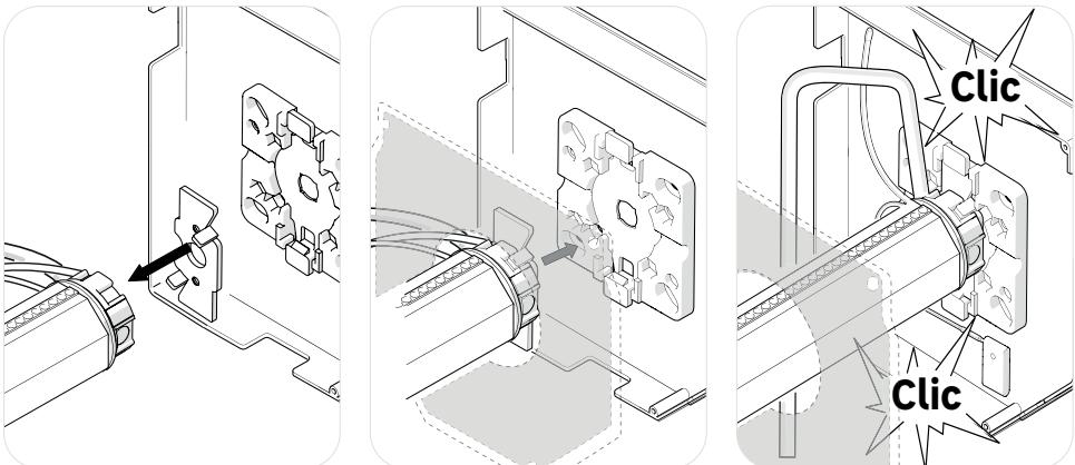
Mai întâi, fixați partea suportului de montare în capul motorului conform poziției prezente mai sus și apoi introduceți capătul produsului care conține cablurile de alimentare și de comunicație în baza de montare furnizată, apoi introduceți clema de fixare până când auziți un clic.
