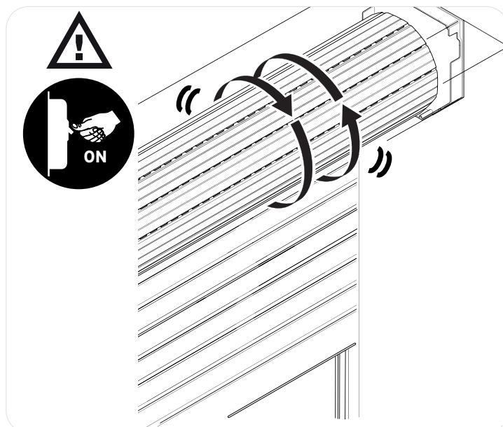
Controllare che il collegamento sia stato effettuato correttamente. Un collegamento errato potrebbe rendere il motore non funzionante e il passaggio precedente non potrà essere eseguito.
