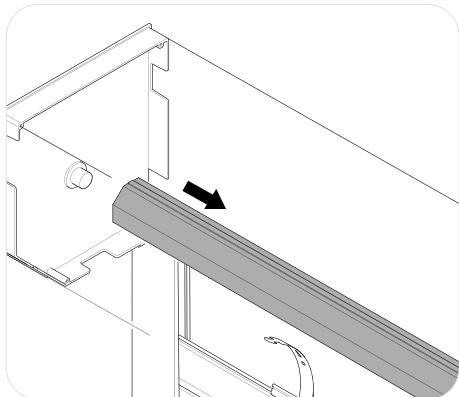
Podczas wymiany silnika należy zabezpieczyć przewód elektryczny, aby uniknąć jego uszkodzenia podczas wyjmowania i wkładania silnika do wału rolety.
