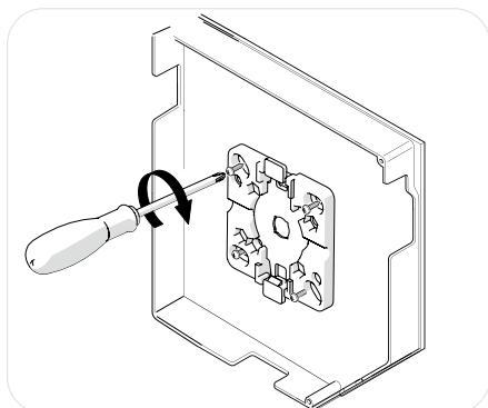
Com parafusos, instale o suporte de fixação antes de instalar o motor da persiana. (Os parafusos de fixação não estão incluídos; utilize os parafusos adequados para o seu tipo de montagem.)
