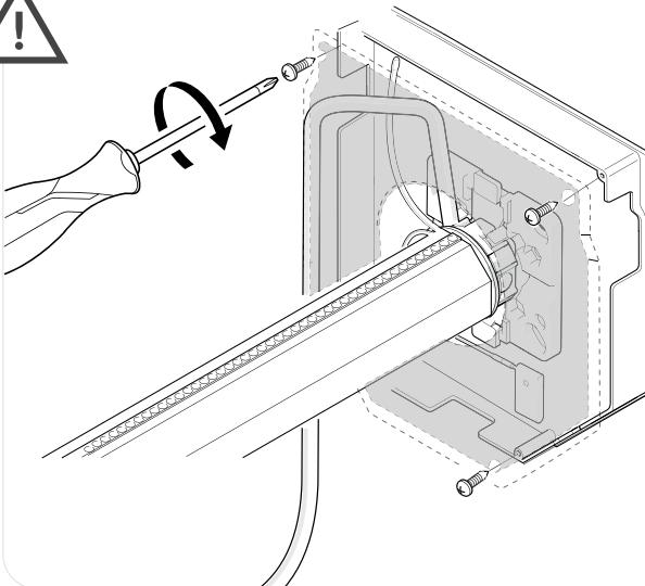
Trecerea cablurilor în spatele capacului este importantă pentru că aceasta să fie protejată și să evite orice risc de încurcare la ridicarea și coborârea oblonului. Instalarea necorespunzătoare a cablului și, prin urmare, deteriorarea acestuia reprezintă o excludere a garanției.
