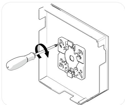
Folosind șuruburi, instalați suportul de montare înainte de a instala motorul oblonului rulant. (Şuruburile de montare nu sunt incluse, vă rugăm să utilizați șuruburile potrivite pentru tipul dvs. de montare.)
