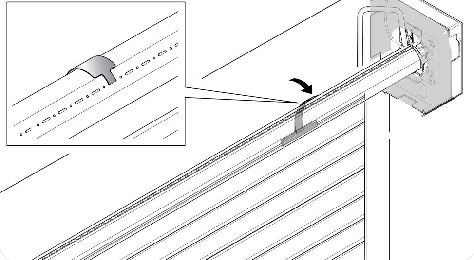
Fixați lamelele oblonului de axă, respectând distanța aşa cum erau înainte de demontare.
