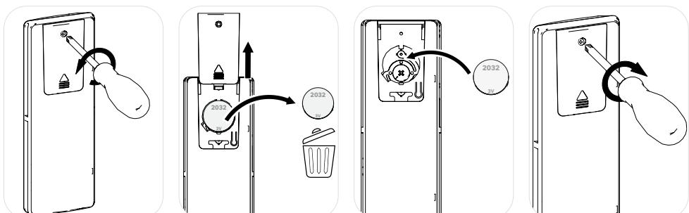
Cu ajutorul unei șurubelnițe în cruce, îndepărtați capacul de la baterie, înlocuiți bateria veche cu o baterie de același tip, glisați capacul și apoi înșurubați pentru a-l închide.
