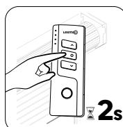
3) Apăsați pe butonul de oprire de pe telecomandă timp de 2s, motorul se va roti spre a treia limită
