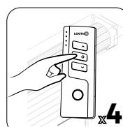
2) Après avoir configuré la limite haute et basse. Appuyez quatre fois sur le bouton d'arrêt de la télécommande.
