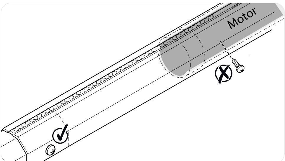
**Atenție:** nu înșurubați șuruburi în axa oblonului pe toată lungimea unde se află motorul pentru a evita orice risc de deteriorare a motorului și risc electric.
