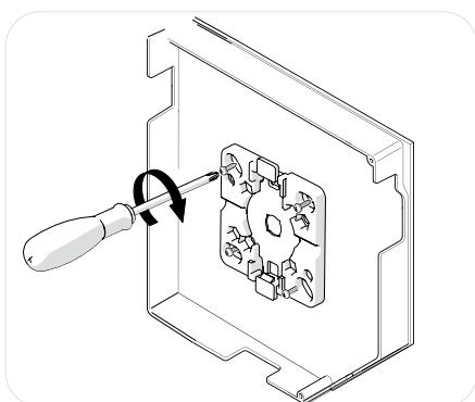
Χρησιμοποιώντας βίδες, τοποθετήστε το στήριγμα στερέωσης πριν από την εγκατάσταση του μοτέρ του ρολού. (Οι βίδες στερέωσης δεν περιλαμβάνονται, χρησιμοποιήστε τις κατάλληλες βίδες για τον τύπο τοποθέτησης.)
