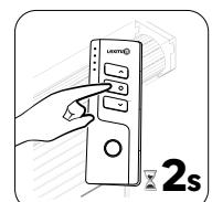
5) Apăsați pe butonul de oprire de pe telecomandă timp de 2s, motorul se va roti spre a treia limită
