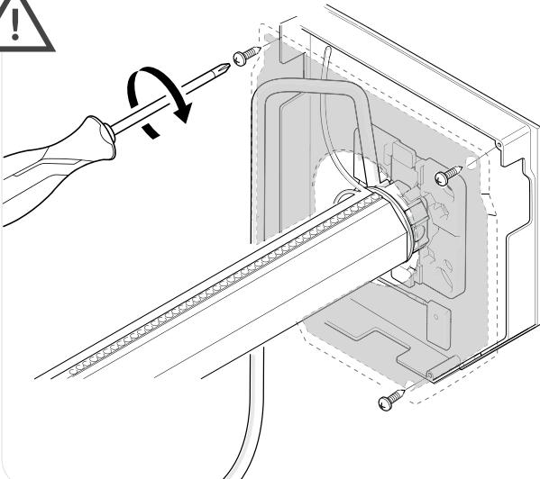
Prowadzenie kabla za osłoną jest ważne, aby go chronić i uniknąć ryzyka wciągnięcia podczas pochylania lub opuszczania rolety. Nieprawidłowa instalacja kabla i wynikające z tego uszkodzenia spowodują unieważnienie gwarancji.
