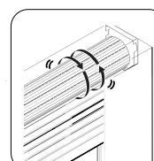
3) Il motore vibrerà: ciò significa che la posizione di arresto è stata impostata come terzo finecorsa.
