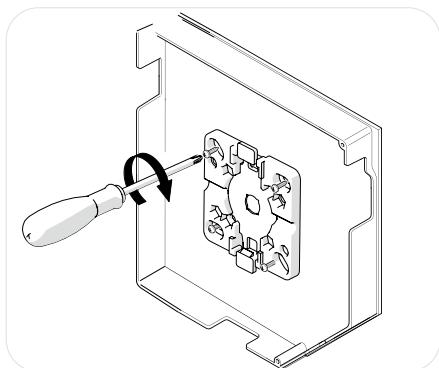
Prima di installare il motore della tappa-rella, installare la staffa di fissaggio con le viti (le viti di fissaggio non sono incluse, utilizzare le viti appropriate per il tipo di fissaggio).
