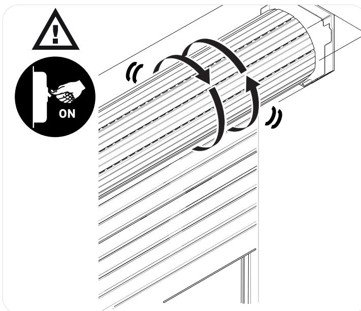
Sprawdzić, czy podłączenie zostało wykonane prawidłowo. Nieprawidłowe podłączenie może spowodować, że silnik nie będzie działał, a poprzedni etap nie zostanie wykonany.
