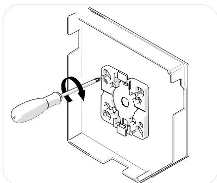
Za pomocą śrub zainstaluj wspornik montażowy przed zainstalowaniem silnika rolety (śruby montażowe nie są dołączone do zestawu, należy użyć odpowiednich śrub do danego rodzaju mocowania).
