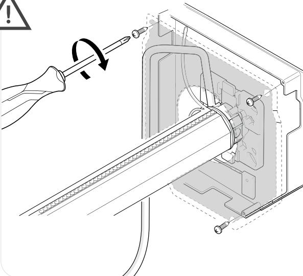
A passagem dos cabos por trás da caixa é importante para que esteja protegida e para evitar qualquer risco de ser puxada quando a persiana é levantada ou baixada. A instalação incorreta do cabo e os danos daí resultantes invalidam a garantia.
