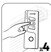
2) Po ustaleniu górnego i dolnego limitu. Naciśnij czterokrotnie przycisk Stop/zatrzymania na pilocie zdalnego sterowania.
