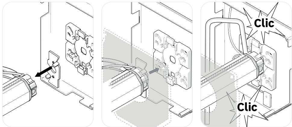
D'abord, enclenchez la pièce du support de fixation dans la tête du moteur selon le positionnement indiqué au-dessus et puis, insérez l'extrémité du produit en contenant les câbles d'alimentation et de communication dans la base de fixation livrée, puis insérez le clip de tenue jusqu'à ce que vous l'entendiez s'enclencher «clic».
