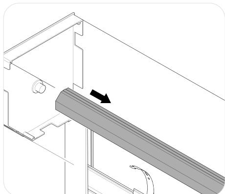
Quando si sostituisce il motore, prestare attenzione a proteggere il cavo elettrico per evitare di danneggiarlo durante la rimozione e l'inserimento del motore nell'albero della tapparella.
