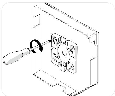
À l'aide de vis, installez le support de fixation avant d'installer le moteur de volet roulant. (Les vis de fixation ne sont pas incluses, veuillez utiliser les vis appropriées pour votre type de fixation.)
