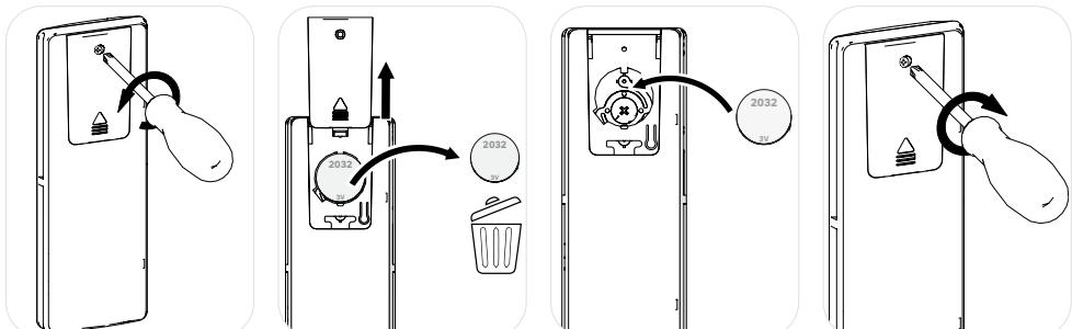
Utilizando uma chave de fendas em cruz, retire a tampa da pilha, substitua a pilha usada por uma do mesmo tipo, volte a colocar a tampa e depois aperte-a.
