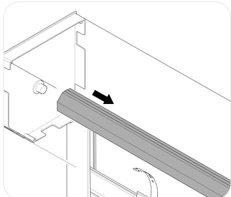
Al sustituir el motor, proteja el cable eléctrico para evitar dañarlo al desmontar e insertar el motor en el eje de la persiana.
