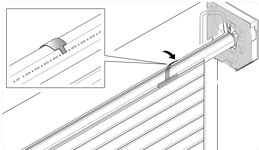
Fissare le lamelle della tapparella all'albero, mantenendo la stessa distanza di prima dello smontaggio.
