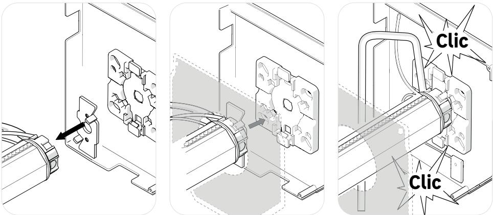
Αρχικά, ασφαλίστε το βραχίόνα τοποθέτησης στην κεφαλή του μοτέρ όπως φαίνεται παραπάνω και στη συνέχεια, τοποθετήστε το άκρο του προϊόντος που περιέχει τα καλώδια τροφοδοσίας και επικοινωνίας στην παρεχόμενη βάση στερέωσης και, στη συνέχεια, τοποθετήστε το κλιπ συγκράτησης μέχρι να ακούσετε τον ήχο κλικ.
