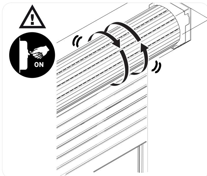
Vérifiez que le branchement a été effectué correctement. Un mauvais branchement peut rendre le moteur inopérant et l'étape précédente ne sera pas réalisée.
