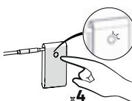
Pulse la tecla del módulo cuatro veces, la luz parpadeará rápidamente. Indica que el motor entra en estado de emparejamiento. La luz desaparecerá una vez que el módulo se haya emparejado.
