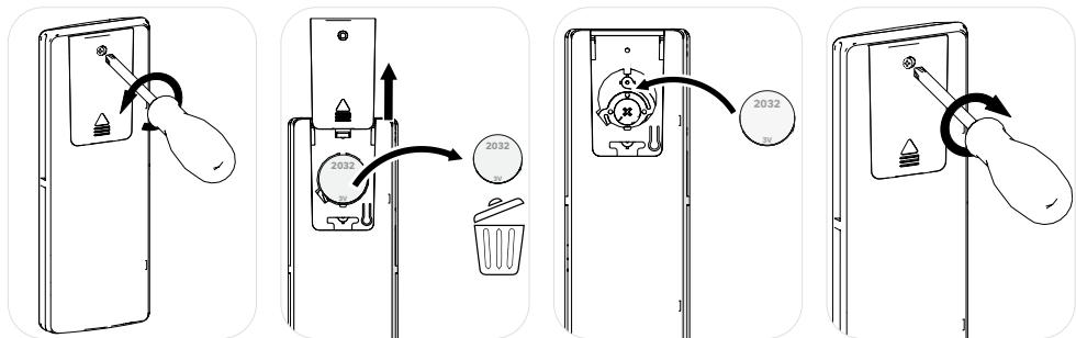
Χρησιμοποιώντας ένα κατσαβίδι με σταυροειδή κεφαλή, αφαιρέστε το κάλυμμα της μπαταρίας, αντικαταστήστε την παλιά μπαταρία με μία του ίδιου τύπου, τοποθετήστε το κάλυμμα και, στη συνέχεια, βιδώστε το.
