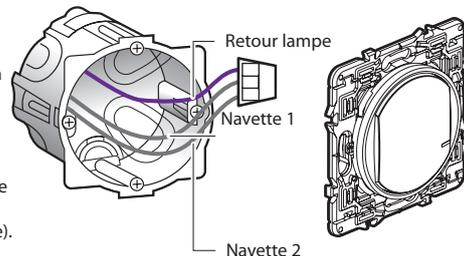
Utilisez un **connecteur** pour raccorder ensemble les 3 fils (navettes 1, 2 et celui du retour de lampe).
