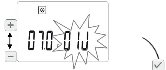
4b. Réglage de la température entre 3°C et 10°C par pas de 0,5°C
