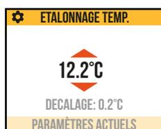
Sur l'écran est affichée la température ambiante détectée par le radiateur dans le point d'installation et la correction éventuelle déjà configurée (DECALAGE).
