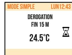
Il est possible de changer ou d'interrompre le fonctionnement temporaire en n'importe quel moment. En tournant le bouton, apparaîtra un menu qui permet d'effectuer l'annulation ou la modification :
