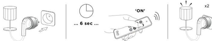
1. Conectar el nano enchufe a la toma de corriente y el enchufe de la lámpara al mini enchufe.
